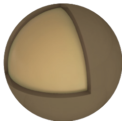
Пигментированный верхний слой микросфер FillGood EVO
